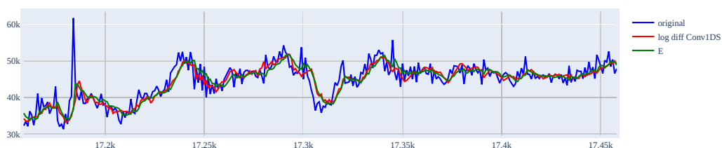
Obr. 12: Porovnanie jedno krokovej predikcie časového radu (Count of all alerts) pomocou Conv1DS siete s log diff škálovacou metódou a kombinácie metód ARIMA a exponenciálneho vyhladzovania.
