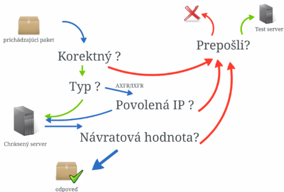
Obr. 10 Schéma sekvenčného spracovania paketu
